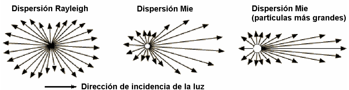
Figura 2.14 Características de las dispersiones Rayleigh (simétrica) y Mie (asimétrica) según el tamaño de las partículas.
