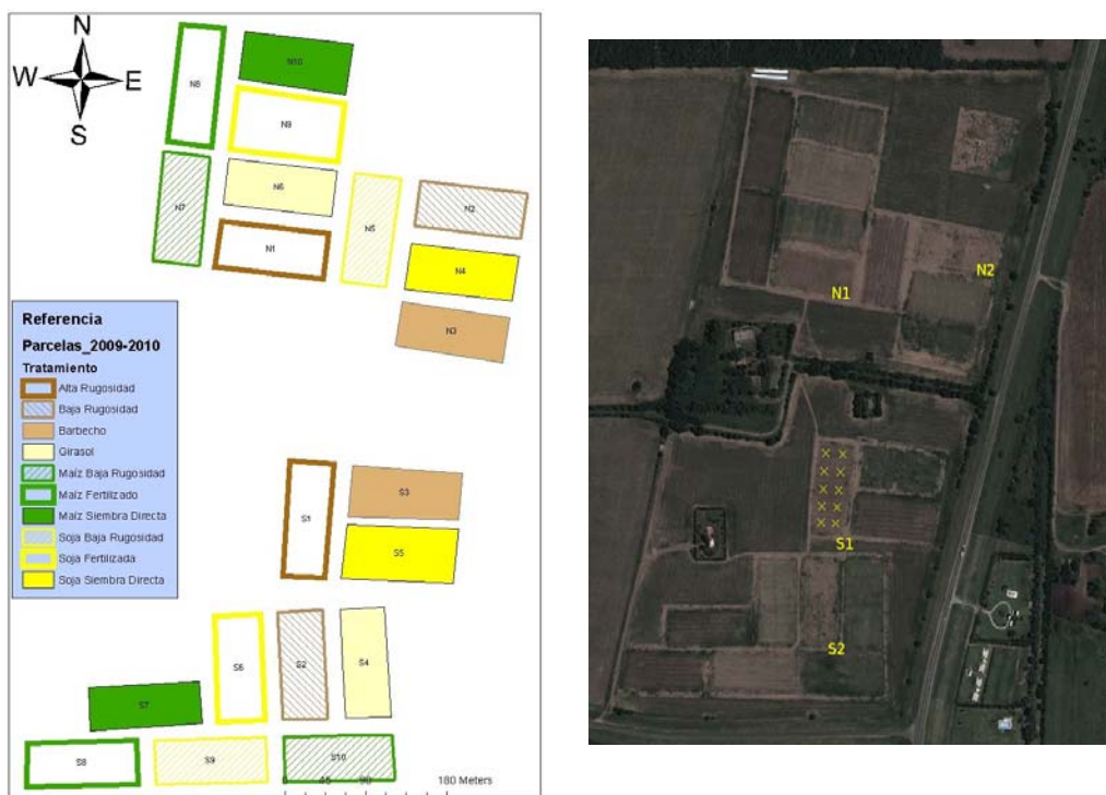
Figura 1: (Izq.) Esquema de las parcelas del CETT al momento de la campaña. Las parcelas N1, S1 se denominan RA (rugosidad alta), mientras que N2, S2 se denominan RB (rugosidad baja). La dirección de la pendiente es Este-Oeste. (Der.) Esquema de mediciones (cruces amarillas) sobre la parcela S1: 10 sitios, 2 mediciones por sitio (rugosidad longitudinal y transversal). Dicho esquema se repite en S2, N1 y N2 (cruces no mostradas).
