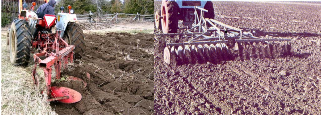
Figura 2: (izq.) Arado de reja y vertedera ( moldboard plow ). (der.) Arado de disco doble acción ( double-acting disk ); nótese las dos hileras de discos una detrás de la otra.
