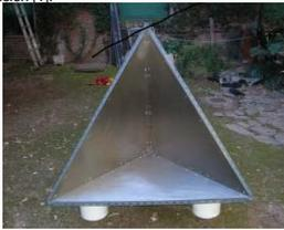
Reflector construido con 1m de lado
